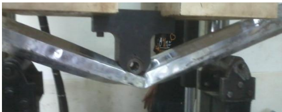
รูปที่ 3 ชิ้นงานเสียรูปร่างถาวรเนื่องจากแรงดัด
